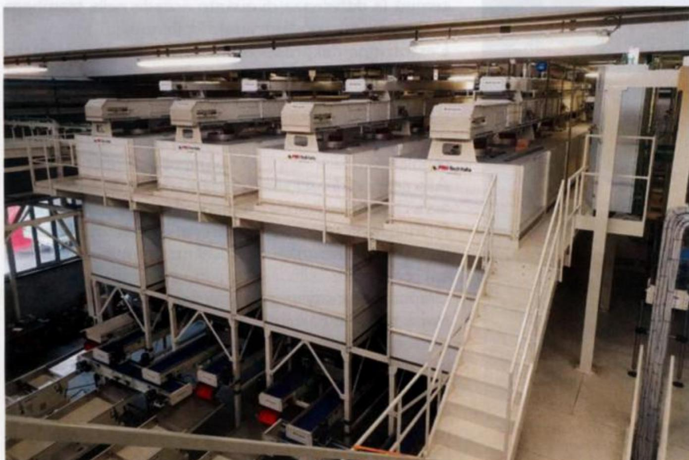
Impianto di insilaggio pasta corta composto da 28 sili con capacità totale di 308 m<sup>3</sup> (Pro-Tech Italia).
