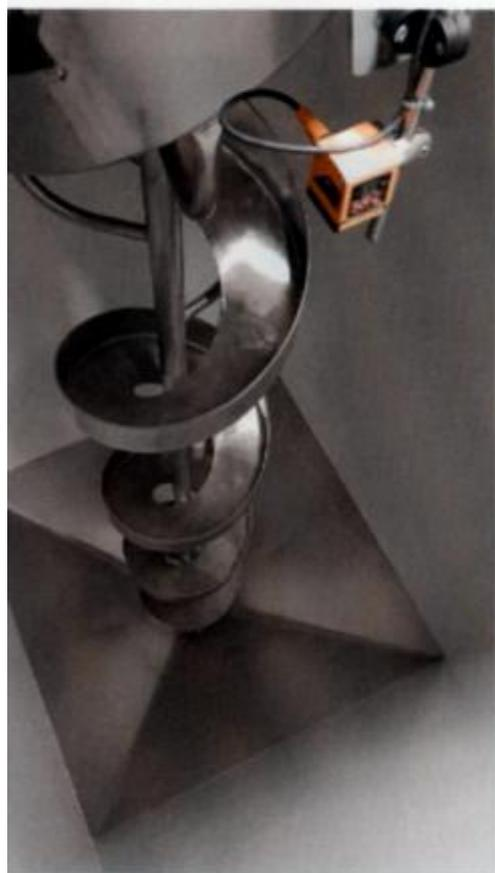
Dettaglio interno di pannelli della cella senza profili metallici e con tramoggia di fondo silos in acciaio inox (Pro-Tech Italia).
